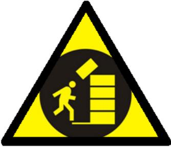
**RIESGO DE DERRUMBAMIENTO:** Esta señal se encontrará cerca de las pilas de andamios, cerchas, formaletas y tableros. Debido a la altura de algunas de estas pilas el derrumbamiento es un riesgo muy real. Esté siempre muy atento a posibles indicios de inestabilidad en las pilas y no permanezca mucho tiempo cerca de ellas.
