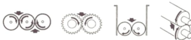
b) Entre partes giratorias y otras con desplazamiento tangencial a ellas: Se presenta en correas y poleas, cadena y rueda dentada, piñón y cremallera, cintas transportadoras, etc. Presentan peligro de atrapamiento y aplastamiento.
