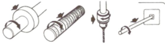
b) Resalte y aberturas: Algunas partes o elementos giratorios son aún más peligrosos por los resaltes o aberturas que poseen (ventiladores, poleas, ruedas de cadenas, engranajes)
